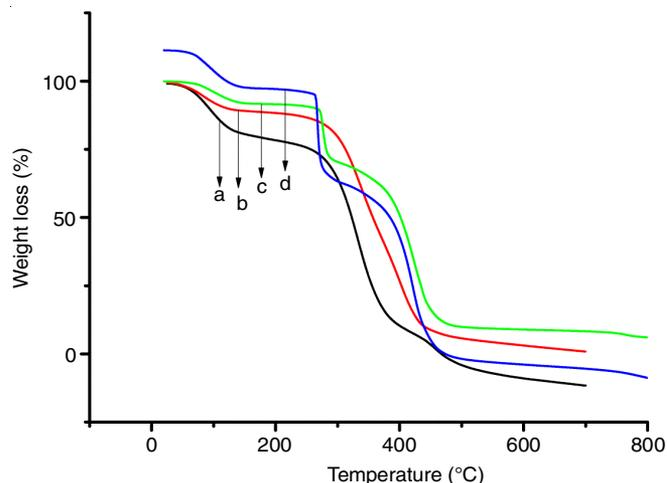
Fig. 3. TGA curve of (a) PVA (b) PVA/PEG (c) PVA/PEG/KC1 and (d) PVA/PEG/KC2
