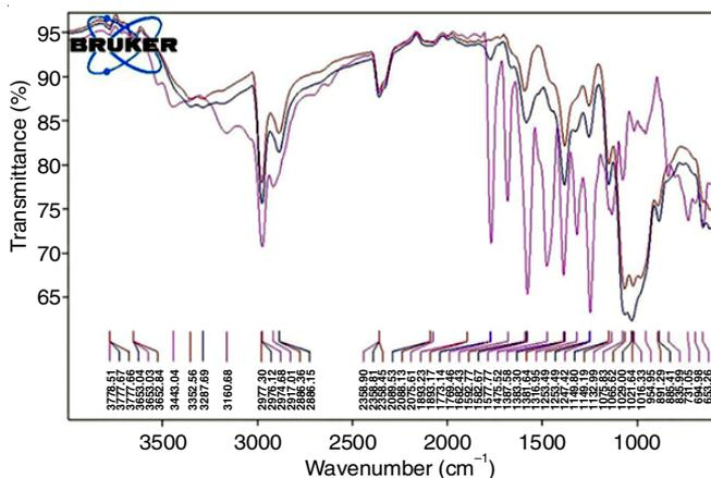
Fig. 1a. FTIR of amoxicillin (— AO), chitosan (— CH), material (— A)
