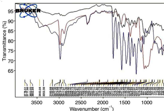
Fig. 1c. FTIR of amoxicillin (— AO), chitosan (— CH), material (— C)
