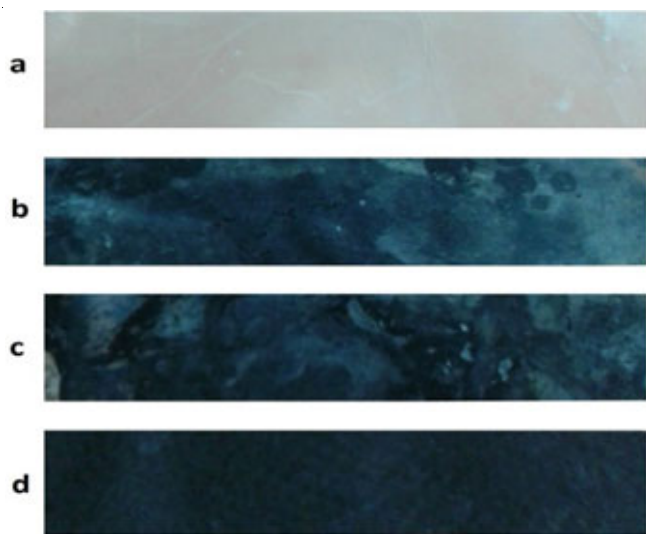
Fig. 6. Film of bacterial cellulose (a), grapheme oxide/bacterial cellulose (GO/BC) 0.04 % wt (b), GO/BC 0.07 % wt (c), GO/BC 0.1 % wt (d)
