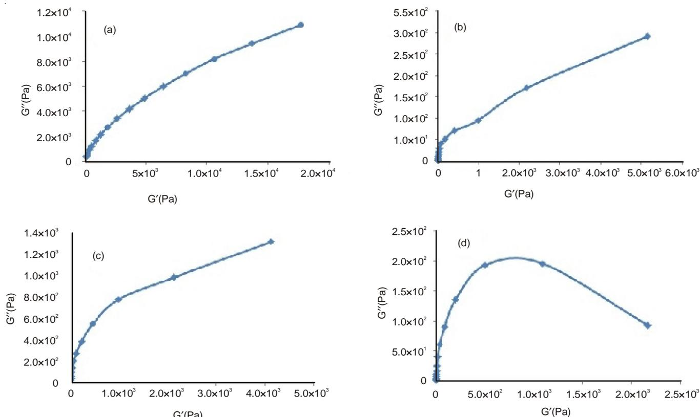
Fig. 10. Cole-Cole plot of (a)NR1 (b) NR2 (c) NR3 (d) NR4 at 40 °C
