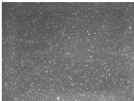
Fig. 1. (d) PLM of isotactic polypropylene with 0.3 wt. % nucleating agent DHDBS
