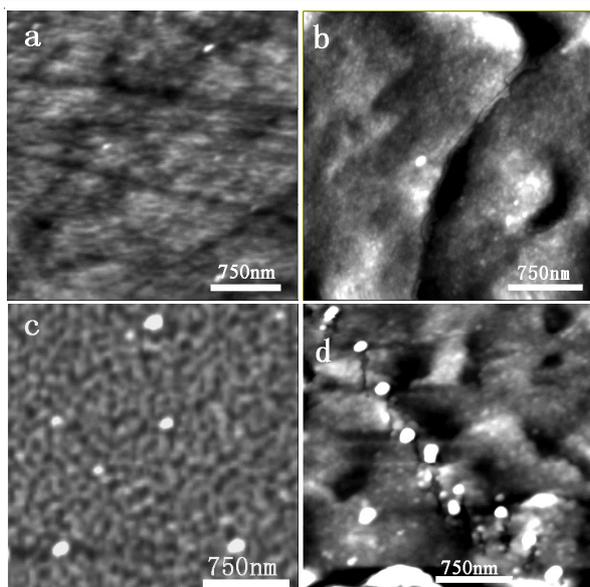
Fig. 1. AFM images of bare GCE (a), CHIT-GO/GCE (b), AChE/GCE (c) and AChE/CHIT-GO/GCE (d)
